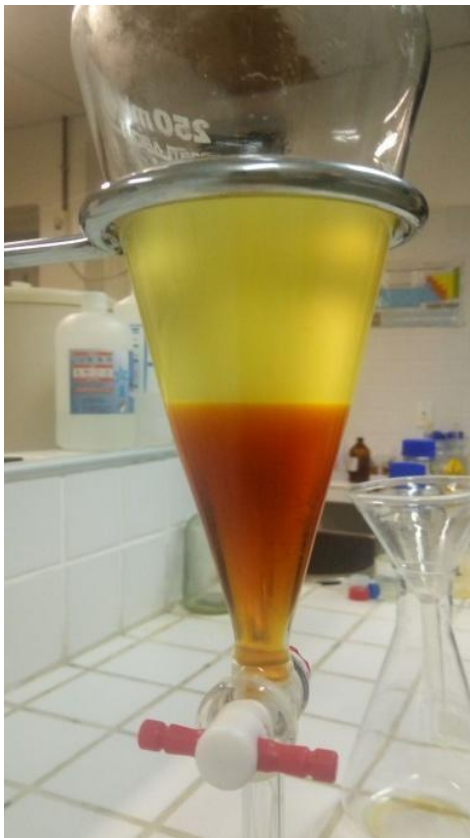
Figura 11 – Demonstração da separação nítida entre biodiesel e glicerina
