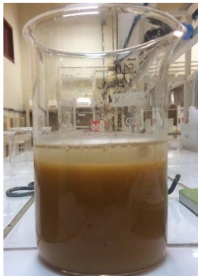
Figura 3 – Efluente tratado com sulfato de alumínio comercial
